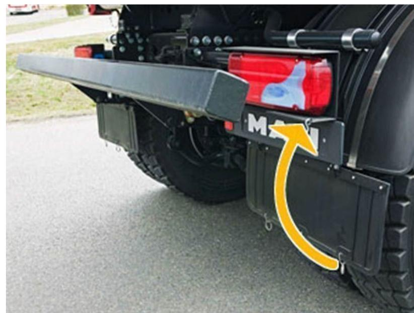
**230AP Barra paraincastro posteriore basculante per finitrice.**
